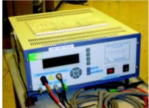
Прибор для измерения характеристик изоляции
