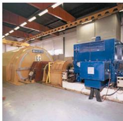
Тестирование на воздействие токов короткого замыкания 400 кА, при напряжении 480 В пер. тока.
