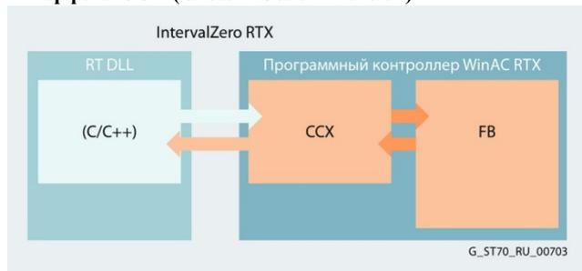
Приложения, использующие интерфейс CCX, способны работать в среде Windows и IntervalZero RTX, поэтому при разработке таких приложений отсутствуют ограничения на состав используемых языковых элементов. CCX приложения выполняются как DLL в среде Windows и как DLL реального масштаба времени в среде IntervalZero RTX.
