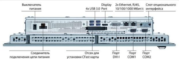
SIMATIC HMI IPC477D с интерфейсом MPI/ PROFIBUS DP
