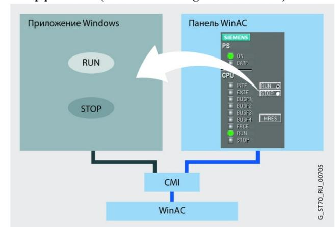
Интерфейс CMI позволяет интегрировать в различные компьютерные приложения функции панели управления центральным процессором WinAC RTX (F). За счет этого компьютерные приложения получают возможность:
