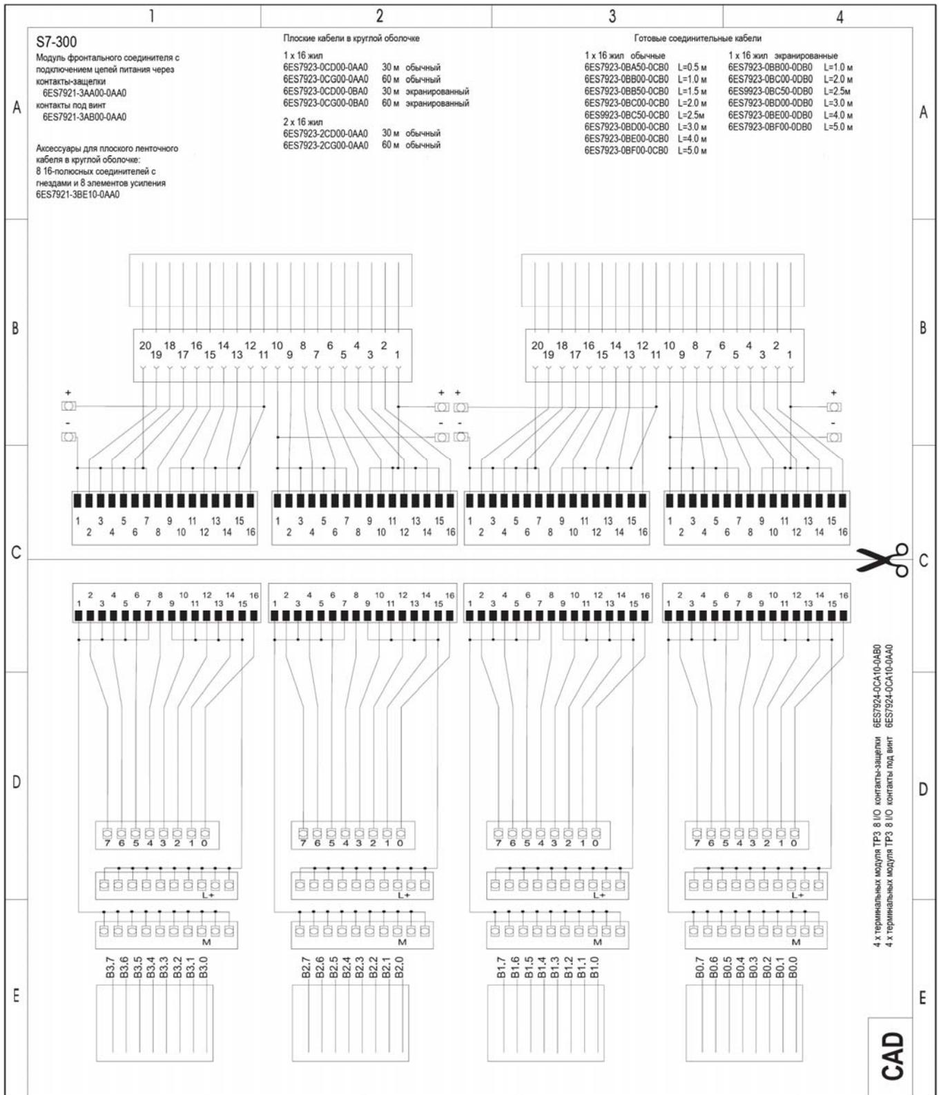
4 x терминальных модуля TP3 8 I/O контакты-защелки 6ES7924-0CA10-0AB0
