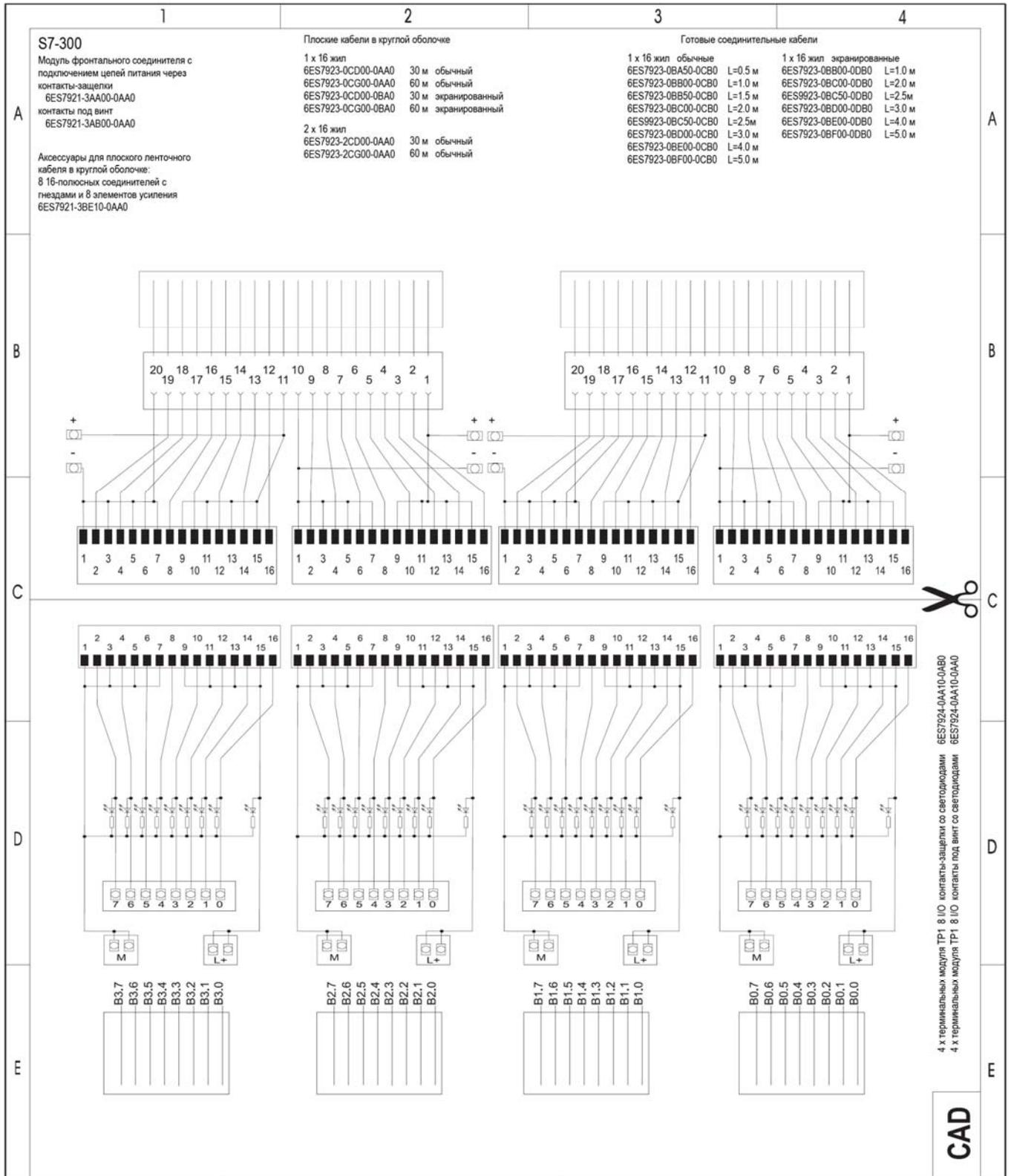
4 x терминальных модуля TP1 8 I/O контакты-защелки со светодиодами 6ES7924-0AA10-0AB0
