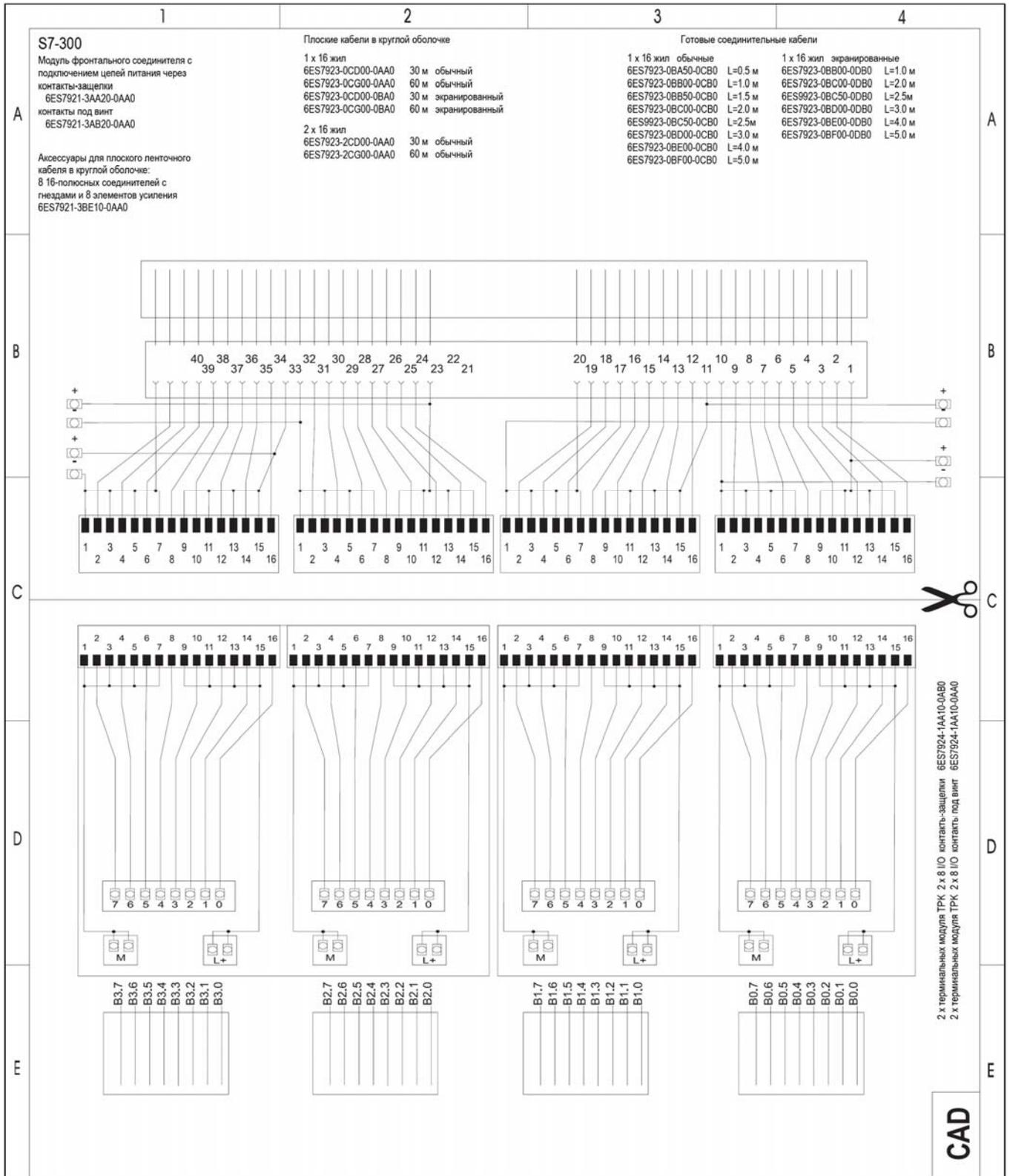
2 x терминальных модуля ТРК 2 x 8 I/O контакт-защели 6ES7924-1AA10-0AB0
