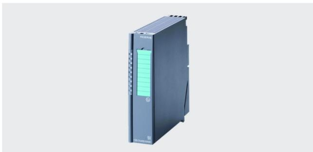
Ложные модули используются для резервирования посадочных мест, на которые впоследствии будут устанавливаться другие электронные модули. Ложный модуль не имеет связи с клеммами подключения внешних цепей терминального модуля. Поэтому монтаж внешних цепей может быть выполнен задолго до установки соответствующего электронного модуля.
