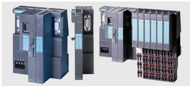
Оptionальный интерфейсный модуль ведущего устройства PROFIBUS DP способен работать под управлением интеллектуальных интерфейсных модулей IM 151-7 CPU, IM 151-7 F-CPU, IM 151-8 PN/DP CPU и IM 151-8F PN/DP CPU параллельно с их встроенными интерфейсами. Он устанавливается непосредственно на профильную шину DIN справа от интел-
