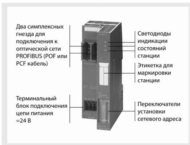
Модули IM 151-1 (FO) монтируются непосредственно на стандартную профильную шину DIN без использования терминальных модулей. Каждый модуль снабжен:
