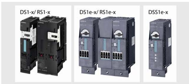
Силовые модули фидеров нагрузки представляют собой готовые пусковые комбинации для коммутации и защиты силовых цепей питания 3-фазных электродвигателей переменного тока. Каждый силовой модуль включает в свой состав автоматический выключатель, электромеханический контактор или устройство плавного пуска, а также электронику управления работой силового модуля.
