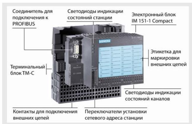
Станция ET 200S Compact состоит из терминального блока TM-C и электронного блока IM 151-1 Compact.
