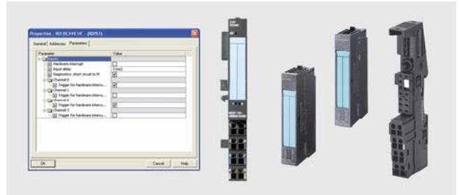
Первая установка электронного модуля на терминальный модуль сопровождается автоматическим выполнением операции механического кодирования терминального модуля. В дальнейшем на этот терминальный модуль не могут устанавливаться электронные модули других типов.
