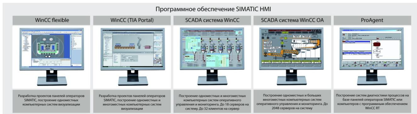
Программное обеспечение SIMATIC HMI (Human-Machine Interface – человеко-машинный интерфейс) объединяет широкий спектр инструментальных средств разработки проектов панелей операторов, одно- и многоместных компьютерных систем оперативного управления и мониторинга, среду выполнения готовых проектов на компьютерах, инструментальные средства разработки систем технической диагностики и т.д.
