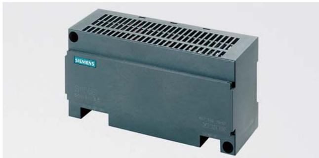
Блоки питания SITOP Power E24/3.5 предназначены для питания центральных процессоров и модулей программируемых контроллеров S7-200, а также их внешних цепей. Они выполняют преобразование входного однофазного напряжения переменного тока промышленной частоты в стабилизированное выходное напряжение  $\approx 24$  В и обеспечивают электронную защиту от коротких замыканий в цепи нагрузки.
