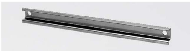
Профильные шины DIN 35x 7.5 мм являются конструктивной основой для установки модулей программируемых контроллеров S7-200. Серийно выпускается несколько разновидностей профильных шин, отличающихся длиной и предназначенных для установки в различные типы стандартных шкафов управления.
