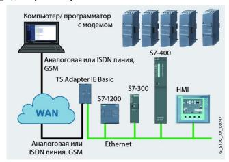
Адаптер TS Adapter IE Basic предназначен для дистанционного обслуживания программируемых контроллеров S7-1200, S7-300, S7-400, а также приборов человеко-машинного интерфейса. Он имеет модульную конструкцию и состоит из базового модуля TS Adapter IE Basic, дополняемого одним из следующих TS модулей:
