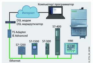
Модуль TS Adapter IE Advanced позволяет получать удаленный доступ через Интернет ко всем системам автоматизации, подключенным к Industrial Ethernet. Адаптер способен взаимодействовать с компьютерами/ программаторами, работающими под управлением операционных систем
