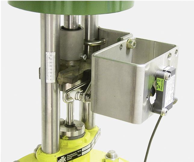
Бесконтактный датчик (6DR4004-NN30) для перемещений  $> 14$  мм (0,55 дюйма), установленный при помощи монтажного набора для поступательного привода NAMUR
