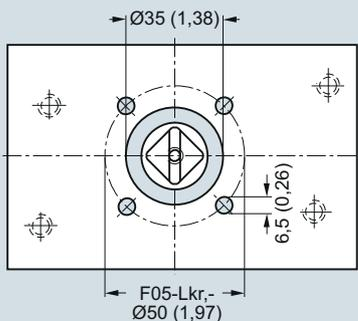
Монтаж на поворотных приводах, монтажные кронштейны (объем поставки от производителя привода), извлечение из VDI/VDE 3845, размеры в мм (дюймах)
