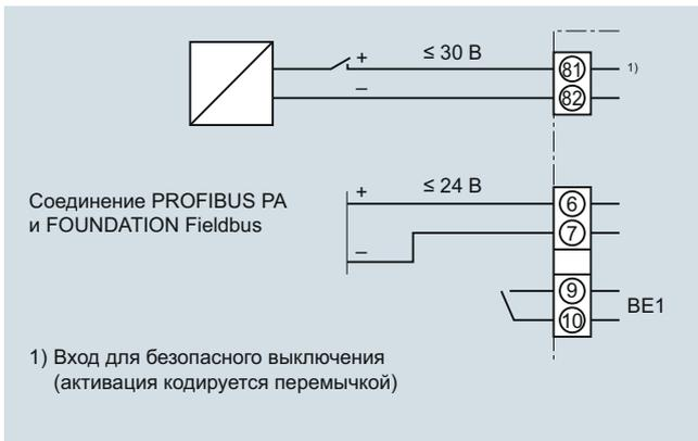
1) Вход для безопасного выключения (активация кодируется перемычкой)
