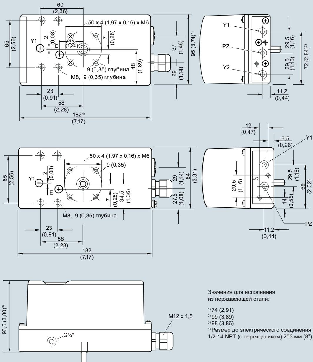
Корпус Makrolon и корпус из нержавеющей стали (вверху), алюминиевый корпус (по центру), корпус Makrolon, корпус из нержавеющей стали и алюминиевый корпус (внизу), размеры в мм (дюймах)
